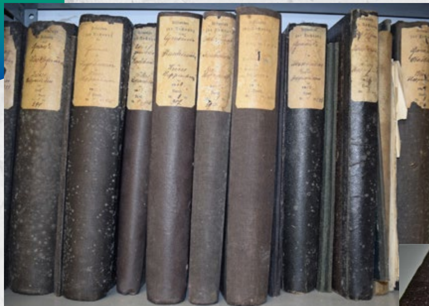
Abb. 1: Amtsbücher des Bestandes E 3 des Stadtarchivs Heppenheim mit Schimmelbefall vor der Reinigung
